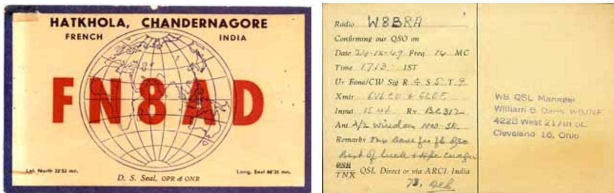
A la vue des cartes QSL de 1949, on peut lire que Deb avait un tube 6L6 au P.A., avec une puissance de 12 à 15 watts, une antenne window et un récepteur BC-312 ou Philips 390. Station bien modeste, lorsqu'on est l'unique représentant actif pour un pays DXCC !
